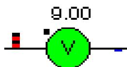
Para medir la tensión, el voltímetro o el polímetro deben conectarse en paralelo con el
