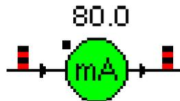
En este caso la **A** se ha sustituido por **mA** porque la corriente es mucho menor que un amperio y por lo tanto se mide en miliamperios ( $80 \text{ mA} = 0,08 \text{ A}$ ). El punto indica, como en el voltímetro, el polo positivo.
